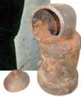
富田式暗渠排水の土管↓
